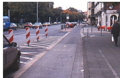
Freihalten der Sicht durch Sperrfläche mit Bake (Hannover)
