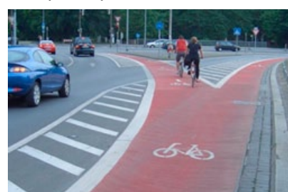
Reduzierung der Abbiegegeschwindigkeiten und Verdeutlichung Konfliktstelle (Hannover)
