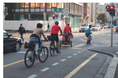
Pilotprojekt Basel: In einer zeitgleich geschalteten Fuß- und Radverkehrsphase dürfen Radfahrende die Kreuzung in alle Richtungen überqueren. Angezeigt wird dies durch ein gelbes Blinkzeichen mit Fahrradsymbol neben der roten Kammer der LSA für den Kfz-Verkehr. Bei der Querung müssen Radfahrende den zu Fuß gehenden Vortritt gewähren. Der Versuch wird im Jahr 2014 ausgewertet (Info Bulletin, Zeitschrift der Velokonferenz 2/2013, S. 19).
