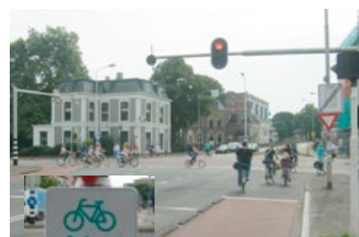
Pilotprojekt Basel: In einer zeitgleich geschalteten Fuß- und Radverkehrsphase dürfen Radfahrende die Kreuzung in alle Richtungen überqueren. Angezeigt wird dies durch ein gelbes Blinkzeichen mit Fahrradsymbol neben der roten Kammer der LSA für den Kfz-Verkehr. Bei der Querung müssen Radfahrende den zu Fuß gehenden Vortritt gewähren. Der Versuch wird im Jahr 2014 ausgewertet (Info Bulletin, Zeitschrift der Velokonferenz 2/2013, S. 19).
