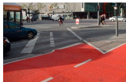
An einem hochbelasteten Knoten in Hamburg wird geradeaus fahrender und linksabbiegender Radverkehr während der Sperrzeit aller Kfz-Verkehrsströme dieser Zufahrt über den zweistreifigen Rechtsabbieger zu einer Aufstellfläche vor der Haltlinie für den Kfz-Verkehr (geradeaus und linksab) geführt. Hier erhalten Radfahrende ein Vorlaufgrün.
